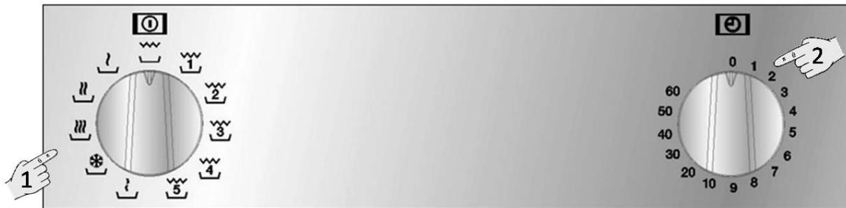
1. Gire el **selector de funciones** hasta colocarlo en la función **Microondas**.
