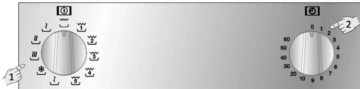
1. Rode o **Selector de Funções** para a posição correspondente à função **Microondas**.
