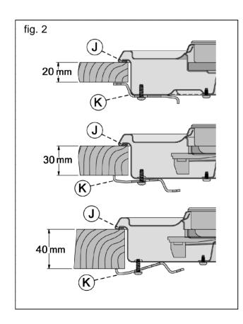
Coloque os grampos (K) como indica a figura 2, fixando-as nos orifícios da parte inferior da estrutura através dos parafusos auto-roscantes fornecidos (Ø 4,2 mm).
