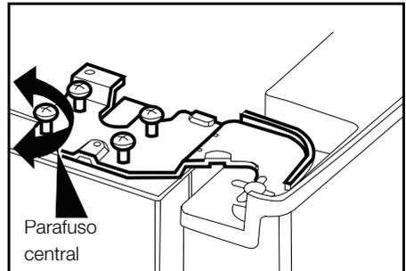
**i** Ajuste a porta adequadamente conforme pretendido, apertando os parafusos.
