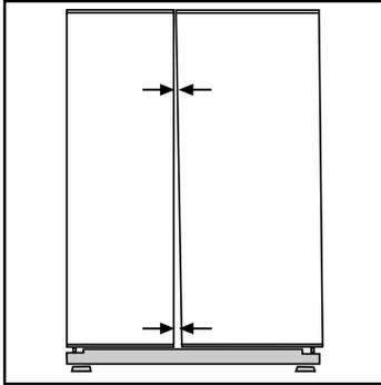
**i** Pode ajustar o espaço entre as portas do compartimento do refrigerador, conforme ilustrado nas figuras.
