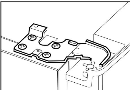
**i** Com uma chave de fendas, remova o parafuso da cobertura da dobradiça superior que pretende ajustar.
