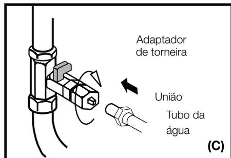
⚠ Aviso: Certifique-se de que a adaptação da válvula padrão de 1/2" alimentada pelo fornecimento de água fria se encontra disponível e está completamente desligada.
