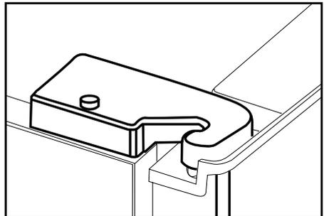
**i** Fixe a porta que ajustou apertando os parafusos, sem alterar a posição da porta.
