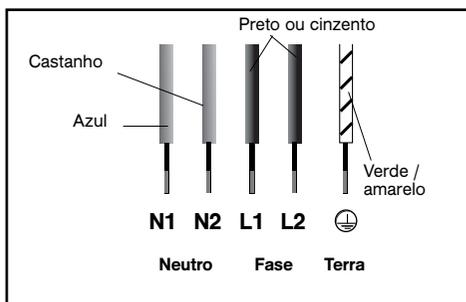
Durante a ligação eléctrica 400 V 2N trifásica, verifique se o fio neutro fica bem ligado.
