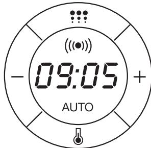
Symbole : S'allume lorsque la fonction Pyrolyse est sélectionnée
