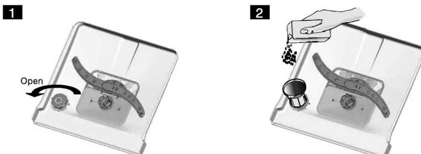
**A** Retire o cesto inferior e desenrosque retirando a tampa do depósito de sal (1)
