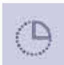
Passados 10 min da sua configuração, permite desligar o motor de aspiração, fechar o painel e apagar as luzes, se acesas. A função selecionada é sinalizada pelo piscar do led da velocidade configurada. A anulação do temporizador é feita pressionando novamente a tecla.
