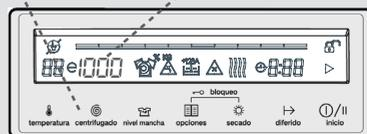
Pode reduzir gradualmente a velocidade de rotação entre as opções de cancelamento da centrifugação (--) através da rotação máxima de centrifugação do programa seleccionado, pressionando o botão de definição da velocidade de rotação.
