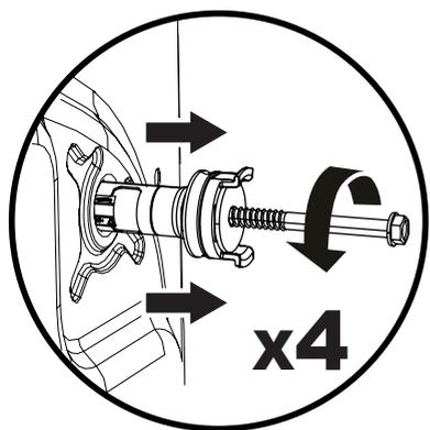
Os parafusos de transporte devem depois ser removidos puxando-os para fora. Os parafusos de segurança do transporte removidos devem ser guardados para serem utilizados novamente em caso da máquina precisar novamente de ser transportada, por exemplo, se mudar de casa.
