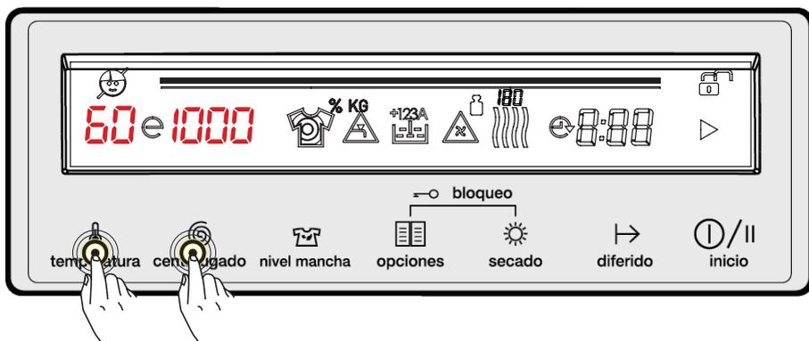
• Toque no botão de definição da temperatura (–, 30°C, 40°C, 40°C e, 50°C, 60°C, 60°C e, 70°C, 80°C, 90°C) para definir a temperatura.
