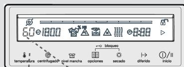
Sempre que seleccionar um novo programa, a temperatura máxima da água de lavagem é exibida no visor de temperatura da água de lavagem.
