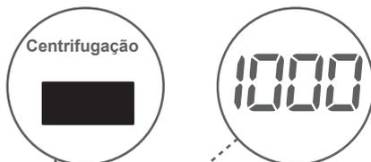
Quando selecciona um novo programa, a velocidade máxima de rotação da centrifugação do programa que seleccionou será visualizada no visor de velocidade da rotação.
