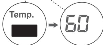
Pode diminuir gradualmente a temperatura da água de lavagem entre a temperatura máxima e a lavagem a frio (--), pressionando o botão de ajuste da temperatura da água de lavagem.
