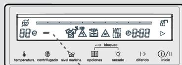
Se tiver saltado a rotação da centrifugação que pretende definir, pode comutar novamente a rotação mantendo pressionado o botão de definição da rotação.
