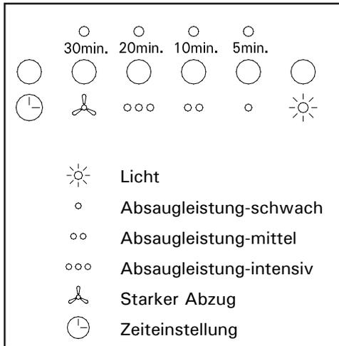
Um eine bessere Absaugleistung zu erzielen, empfehlen wir Ihnen, das Gerät einige Minuten vor dem Kochen einzuschalten, damit der Luftstrom bei Kochbeginn den Dunst dauerhaft und gleichmässig absaugt.
