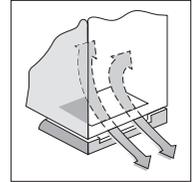
Es ist darauf zu achten, daß die Öfen, wie oben angegeben, absolut stabil befestigt sind und daß die elektrischen Teile derart isoliert sind, daß sie nicht mit den Metallteilen in Berührung kommen. Außerdem muß der Kleber, der das Laminat mit dem Möbel verbindet, einer Temperatur nicht unter 90°C widerstehen, um Verformungen und Abkleben der Verkleidung zu vermeiden.
