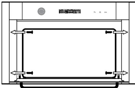
O rodapé e o plano da base onde é instalado o forno devem ser fresados tal como indicado a fim de permitir uma segura tomada de ar e uma livre circulação do ar à volta do forno.
