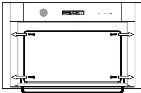
• Basen og basepladen, der er anbragt under ovnen, skal fræses i overensstemmelse med angivelserne . Herved sikres en korrekt ventilation og en korrekt luftcirkulation omkring ovnen, således at ovnen fungerer korrekt og køkkenelementerne ikke beskadiges.
