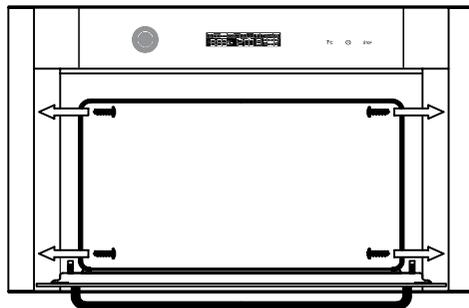
Pour permettre une arrivée d'air correcte et la libre circulation de l'air tout autour du four, le socle et le plan de base doivent être découpés selon le schéma ci-contre.
