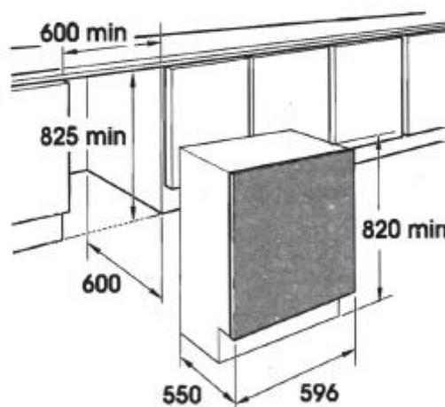
Os 4 pés reguláveis permitem fazer variar a altura da máquina desde 820 mm (remover as porcas e substituir pelas de 5 mm) até 840 mm de máximo. Não esquecer de bloquear os fechos das porcas na base de fundo.
