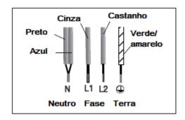
Em caso de mau funcionamento da placa de cozinha com uma ligação de 400 V 3N trifásica, verifique se o fio neutro está devidamente ligado.
