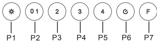
P1: krátké stisknutí zapnutí/vypnutí světel, zapnutí/vypnutí kontrolky LED P1.
