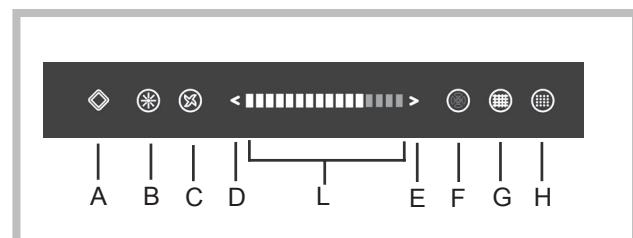
**A = Tlačidlo Stand-by/OFF.** Pokiaľ je odsávač vypnutý, toto tlačidlo je jediné, ktoré je podsvietené. Po stlačení tlačidla sa aktivuje režim stand-by. V prípade, že odsávač neprijme ďalšie príkazy do 5 minút, režim stand-by sa vypne. V režime stand-by tlačidlo svieti, a tlačidlá B, C a F sú iba podsvietené. Keď je odsávač pár zapnutý, podržanie stlačeného tlačítka (> 2") spôsobí jeho vypnutie (motor, svetla a časovač, ak je zapnutý).
