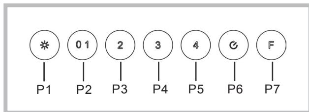
P1: Kort tryk åtænder/slukker lysene, led-lyset P1 tændes/slukkes.
