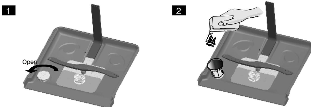
A. Retire o cesto inferior e desenrosque retirando a tampa do depósito de sal (1)
