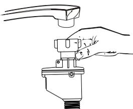
A máquina deve estar ligada a uma entrada de água usando os tubos e conexões fornecidos com o aparelho, não reutilize tubos já anteriormente utilizados.
