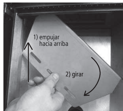
Fig. 17: retirar a placa corta-fogo
