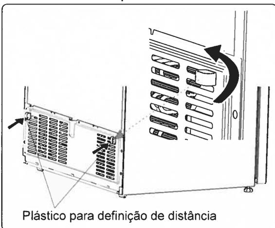
A distância entre o eletrodoméstico e a parede traseira deverá ser, no máximo, de 75 mm.
