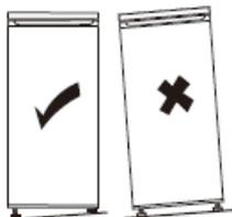
Selecione um espaço para instalar o frigorífico sobre uma superfície plana. Se o aparelho não estiver nivelado, as portas não ficarão corretamente alinhadas e a estanquicidade dos compartimentos poderá não ser assegurada.
