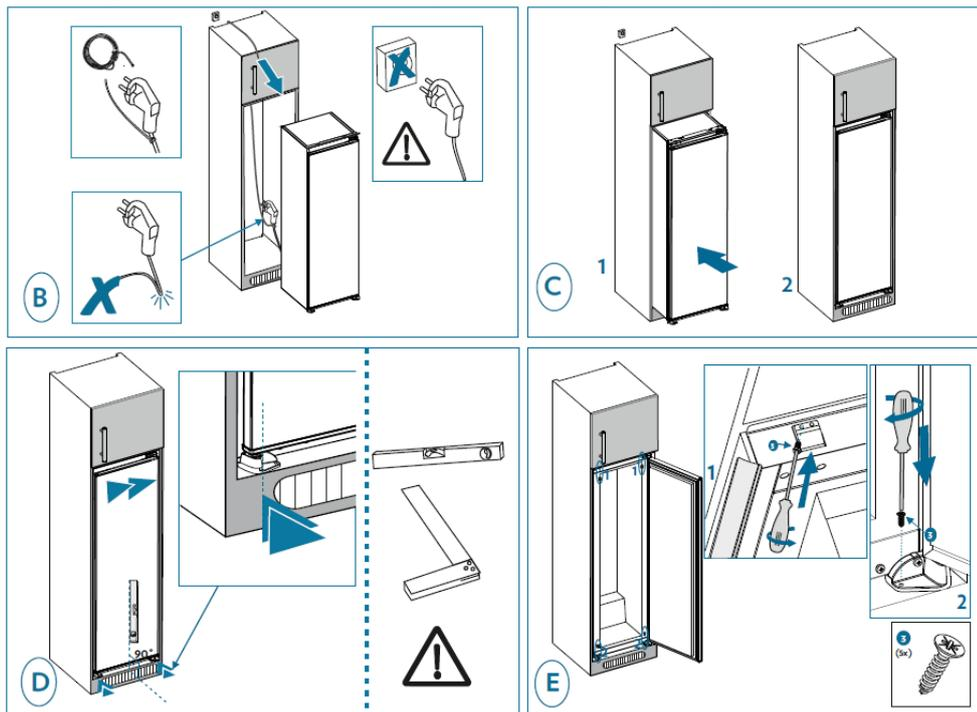
5. Aparafuse uma guia nos orifícios da lateral do dispositivo. Insira a dobradiça na guia e aparafuse-a na porta. Desaperte a guia para aparafusar o último parafuso da corredeira na porta. Coloque a tampa na corredeira. Aparafuse a guia de novo no dispositivo inserindo a corredeira.
