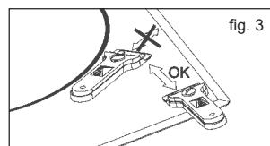
**⚠ Verwenden Sie die Klinge nur auf der keramischen Oberfläche, um zu vermeiden, dass das Schaber Gehäuse mit dem Glas in Berührung kommt, da es dadurch zerkratzt werden könnte.**
