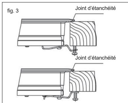
En fonction de l'épaisseur du meuble, il est possible que vous ayez besoin d'utiliser les vis taraudeuses qui sont fournies en complément de fixation, en les insérant dans l'orifice circulaire de l'agrafe. Le filetage de cet orifice se fera quand on y insérera la vis. On doit réaliser ce filetage avant de fixer l'agrafe à la table de cuisson.
