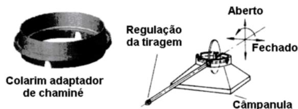
*Nos modelos H-02/22 e TC-1 a regulação faz-se através da porta do cinzeiro, girando o punho.*
