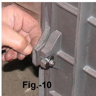
Ajuste manualmente, sem apertar, com a chave N°10, o lateral à traseira com o parafuso, porca e duas anilhas que se fornecem (M6) Fig.10
