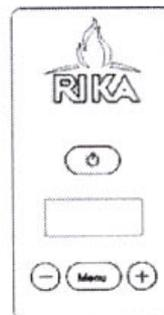
Fig.6 Unidade de controlo interna, funções e teclas.
