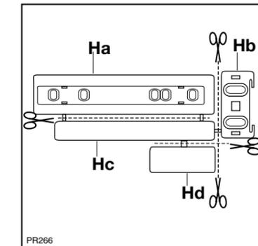
Apoie a guia (Ha) na parte interior da porta do móvel em cima e em baixo como indicado na figura, e marque a posição dos furos externos. Uma vez preparados os furos, fixe a guia com os parafusos anexos.
