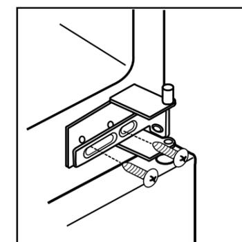
5. Desaparafuse o parafuso inferior e retire o espaçador, voltando a montá-los na parte oposta.
