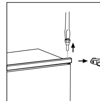
3. Desaparafuse a dobradiça intermédia e as tampinhas tapa-furos, voltando a montá-las na parte oposta.
