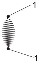
A máquina arremata o ponto e costura unidade a simples do modelo e, em seguida, pára automaticamente após arrematar o ponto.
