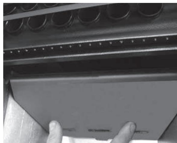
Fig. 14: levantar a placa corta-fogo
