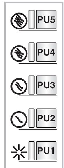
Der Alarm wird bei ausgeschaltetem Motor aktiviert und bleibt 30" lang sichtbar. Zur Deaktivierung des Alarms ist eine der Tasten 2" lang zu betätigen, während der Alarm angezeigt wird.
