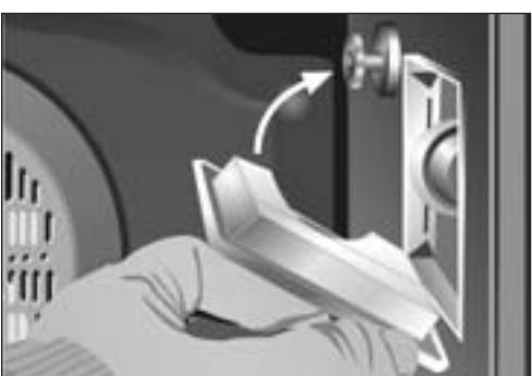
A lâmpada a substituir deve ter uma resistência à temperatura até 300 °C, solicite-a no serviço de assistência técnica.
