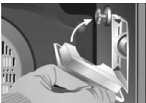
La lámpara a sustituir debe tener una resistencia a la temperatura de hasta 300 °C, solicítela en el servicio de asistencia técnica.
