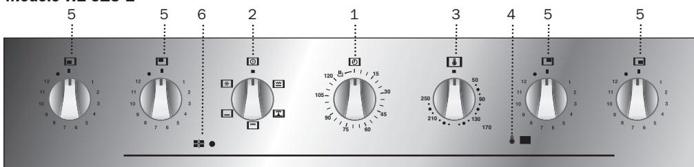
**1** Mando temporizador minutero.**2** Selector de funciones.**3** Selector de temperaturas.**4** Piloto de calentamiento. Indica la transmisión de calor al alimento y se apaga al alcanzar la temperatura seleccionada.**5** Mando para el control de la encimera.**6** Piloto de conexión encimera. Indica que alguno de los fuegos eléctricos de la placa de encimera está conectado.**Funciones del Horno****□ Desconexión del horno****■ Grill y Solera**
