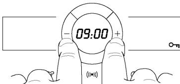
Um die Funktion zu deaktivieren, berühren Sie die Sensoren + und - gleichzeitig, bis 1 akustisches Signal ertönt. Das
