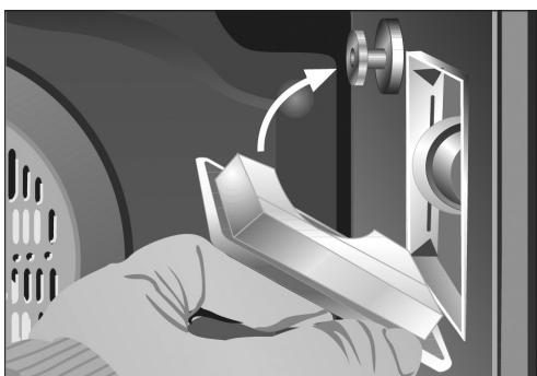
L'ampoule doit être conçue pour résister à des températures allant jusqu'à 300°C, consultez le service d'assistance technique pour la commander.
