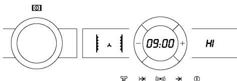
2. Drehen Sie den Temperaturwahlschalter, um zwischen den Auftaustufen LO und HI zu wählen.
