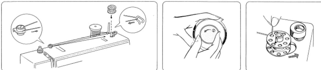
Tirar a linha da bobine ou carreto. Passar o fio através do guia de fio da tampa. Rodar a linha à volta da bobine. Inserir a linha no buraco da bobine, enrolando de dentro para fora. Colocar a bobine no carreto e puxá-lo para a direita.
