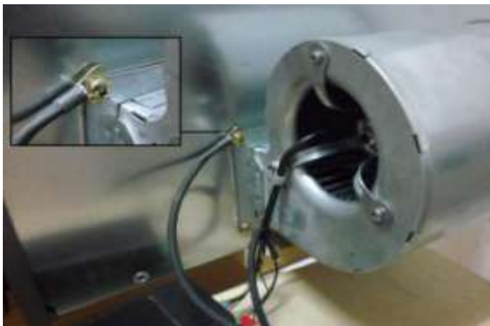
Σχήμα 9 Αριστερά: ανεμιστήρα παράθυρο στη θέση 2 ή 3, με βίδα αντικραδασμική εγκατασταθεί. Εικόνα 9δεξιά: ανεμιστήρας δεμένο γύρω από το παράθυρό του με αισθητήριο NTC αλιεύονται μεταξύ βίδα και
