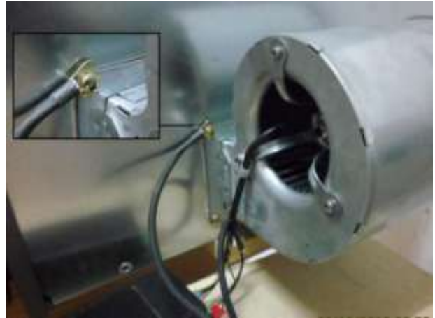
Figura 9 a sinistra: ventilatore finestra in posizione 2 o 3, con trattamento anti-vibrazione vite installata.
