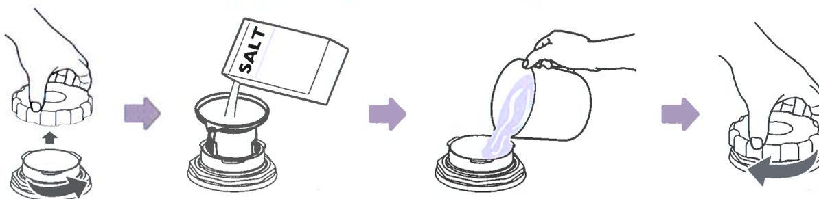
1. Remova a cesta inferior e desparafuse a tampa do tanque.
