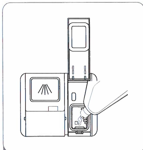
2 Coloque abrilhantador no depósito sem o encher em demasia.
