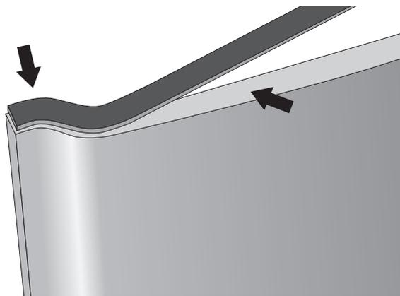
Fig. 16 Anti-vibrações laterais direita e esquerda interiores
