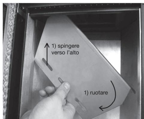
Fig. 14 Retirar a placa corta-fogo
