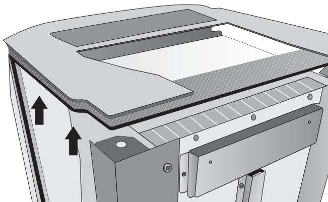
Fig. 16 Anti-vibrações superior e inferior
