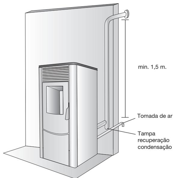
Fig. 4: Instalação do conduto de fumos exterior.
