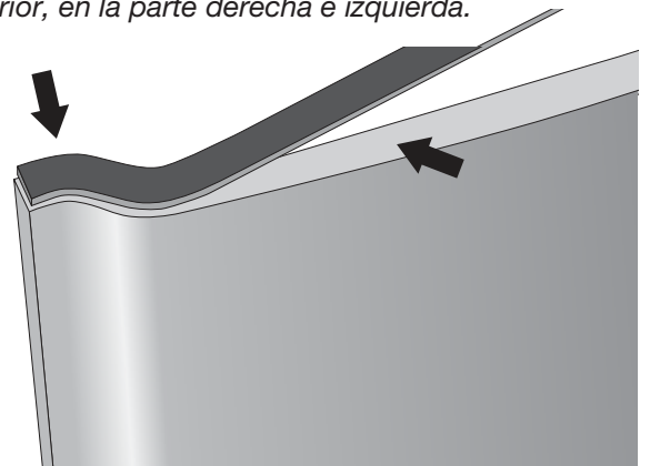
Imagen 16: Pegado de la junta a prueba de vibraciones en el interior, en la parte derecha e izquierda.
