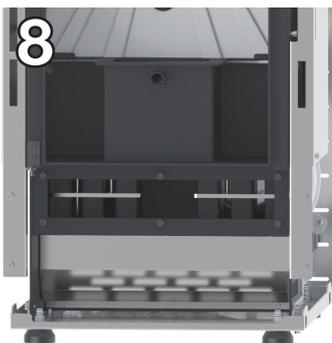
Com um aspirador limpar o material refractário e as paredes da câmara de combustão, em particular a parede frontal na qual estão localizados os raspadores, (foto 9) da parte inferior da câmara de combustão e o compartimento que está localizada abaixo da gaveta de cinzas (foto 8)
