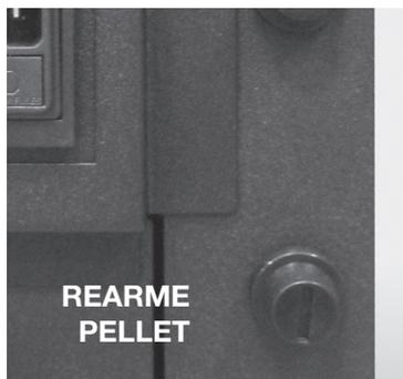
**Segurança temperatura pellets:** nos raros casos em que há um excesso de temperatura no interior do tanque, o termostato de segurança com pastilhas de reset manual gera um alarme **"ALAR-SIC-FAIL"** interromper o funcionamento do estufa; reset deve ser realizada pelo cliente rearmar o referido dispositivo colocado atrás do fogão.
