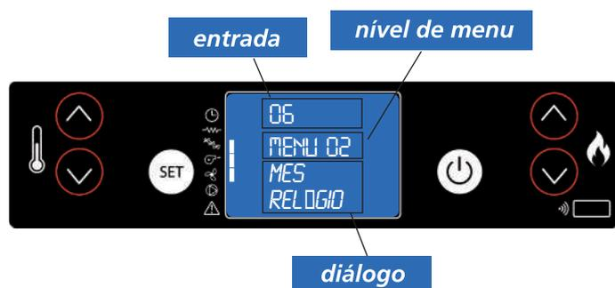
Definir a hora ea data. A placa electrónica está equipado com uma bateria de lítio que permite o relógio interno uma autonomia sobre 3/5 anos.
