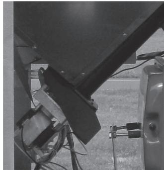
**Motor de redução:** se o motor de redução se detiene para el mensaje **"ALAR-DEP-FAIL"** o **"ALAR-SIC-FAIL"** la caldera continúa a funcionar até que a chama se apague por falta de combustível e até atingir o nível mínimo de arrefecimento.
