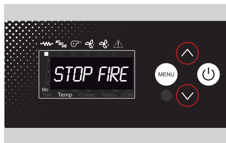
Stop FirE A salamandra está na fase de limpeza do braseiro. O extrator de fumaça funciona na potência máxima.
