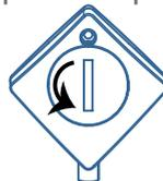
Para inserir a bateria, é preciso desapertar a cobertura no verso da sonda com a ajuda de uma moeda, inserir a pilha respeitando a polaridade (+ em cima) e depois, voltar a apertar. Substituir a pilha quando estiver gasta ou no caso de derrame. A bateria deve ser retirada do aparelho antes de este ser eliminado.
