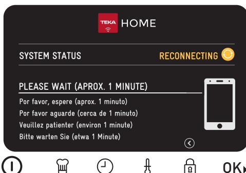
De oven zal automatisch opnieuw te verbinden met het eerder geconfigureerde wifi-netwerk. Als het proces met succes is voltooid, wordt een bericht weergegeven dat de verbinding is gemaakt.
