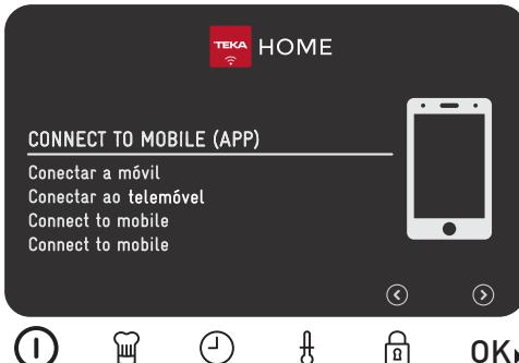
Appuyez sur la touche tactile **OK▶** pour lancer le processus d'appairage. L'écran suivant s'affiche sur le four une fois le processus lancé et pendant le processus d'appairage :
