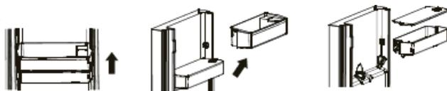
2. Após a limpeza, recolocar o depósito de água, tampa e prateleira do depósito de água como se indica abaixo.
