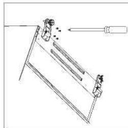
6. Depois de posicionar o aparelho, instalar as portas seguindo o processo inverso.
