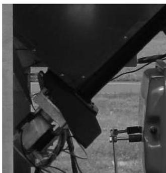
**Motor de redução:** se o motor de redução, a Salamandra Hidro continua a funcionar até que a chama se apague por falta de combustível e até atingir o nível mínimo de arrefecimento.
