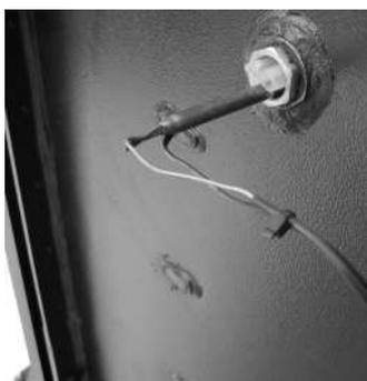
**Sonda de temperatura água:** se a temperatura da água se aproximar à temperatura de apagado (85°C) a sonda impõe para parar a alimentação dos pellets.
