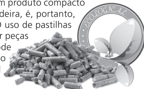
**Para os nossos produtos se tem que usar pellets de 6 mm de diâmetro, comprimento de 30 mm, um teor máximo de humidade de 8% e EN Plus A1 preferencialmente SK002 certificado de acordo com a norma UNI EN ISO 17225-2. Recomenda-se armazenar os pellets longe de fontes de calor e umidade em locais sem ou sem atmosferas explosivas.**
