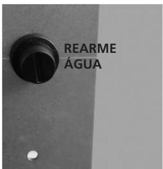
**Termóstato de segurança com rearme manual para a temperatura da água:** se a temperatura da água do tanque ultrapassar o nível da referência de segurança de 85° C, a operação do aquecedor para imediatamente e o display indica **"ALAR-SIC-FAIL"**. Para voltar a acender é necessário restabelecer os valores iniciais manualmente.
