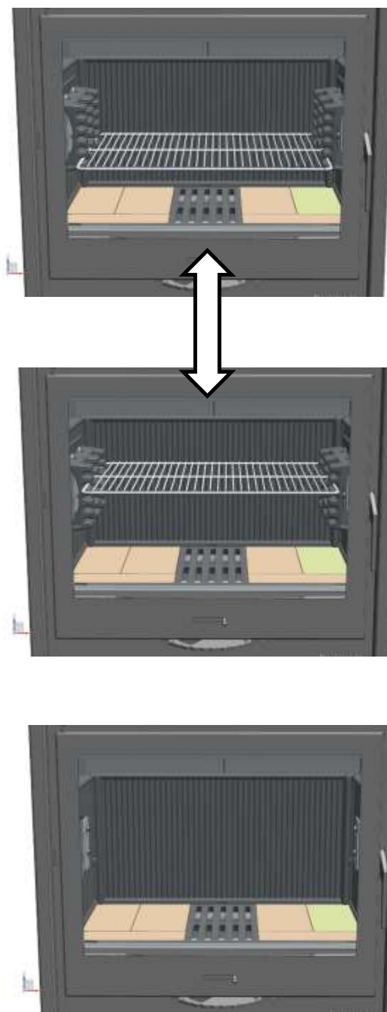
FIG. 6 - DESMONTAGEM DO SUPORTE DA GRELHA
