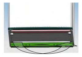
6. Coloque a porta na posição direita, fixe as dobradiças superiores e depois coloque a tampa superior.
